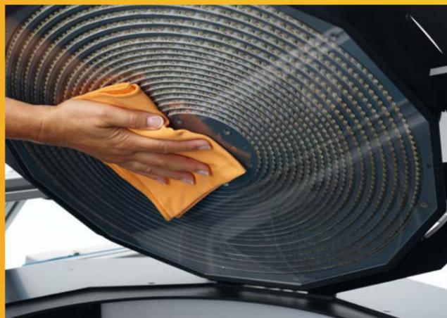
Dioden-Ringe im Deckel: Das Streiflicht kann abhängig vom zu prüfenden Werkteil ringweise zugeschaltet werden.
