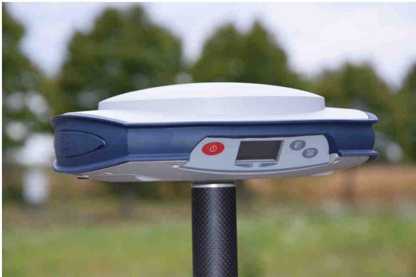
*SP80: das kompakte und tragbare GPS-basierte Tracking System ist ideal zur Fahrzeug-zu-Fußgängerverfolgung und Vermessung der Versuchsumgebung*
