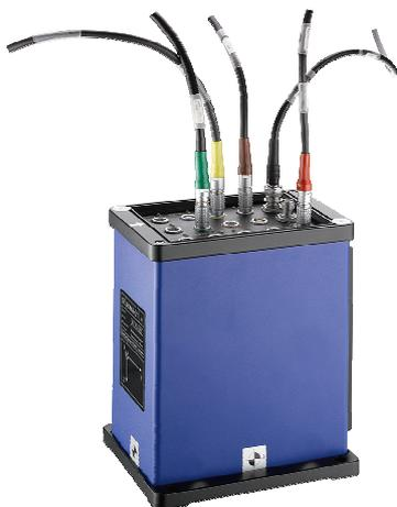
*GNSS/Kreiselpattform ADMA mit einer Ausgaberate von 1000 Hz und geringer Datenlatenz*
