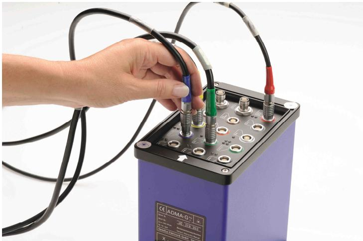
*Neue Generation GPS/Kreiselpattform ADMA mit einer Ausgaberate von 1000 Hz*
