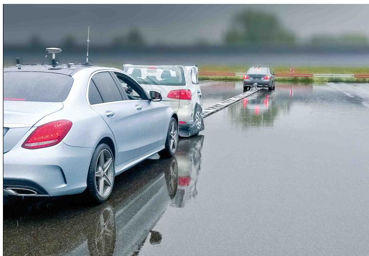
*Zentimetergenaue Messung des Abstandes oder Relativwinkel zwischen mehreren Fahrzeugen, z.B. AEB Tests*
